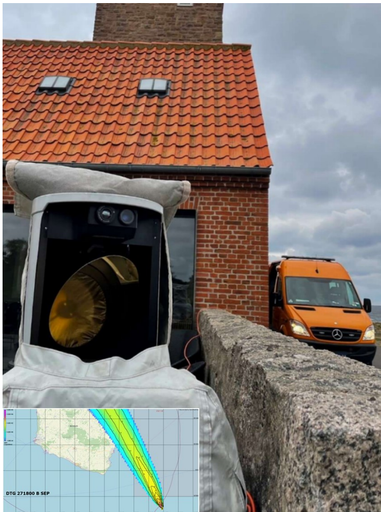
Beredskabsstyrelsens måleenhed i forbindelse med gaslækagerne på Nord Stream 1 og 2, herunder et billede af en ARGOS-spredning, der viser en prognose for gasskyens spredning.
