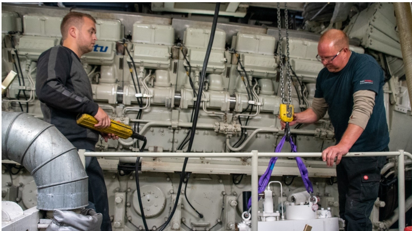
Hovedmotoren på Esbern Snare efterses af fremdrivningsværksted under Vedligeholdelsesområde Frederikshavn.
