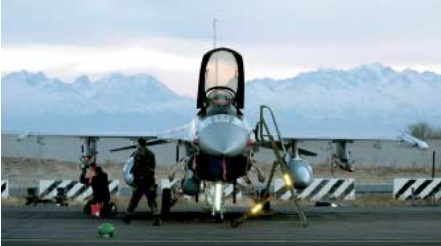
F-16 under klargøring til mission fra Manas i f.m. operation Enduring Freedom. Her udføres kontrol af laserstyret bombe GBU 12. Foto: Brian Jacobsen, Flyvevåbnets Fototjeneste.
