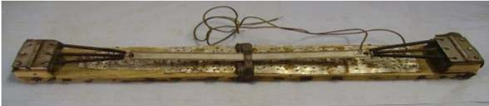
"Pressure plate-udløser" fremstillet af et stykke træ, hængsler fra skabe, en savklinge og fjedre fra en cykelsaddel. Når de to stykker metal presses mod hinanden udløses sprængladningen.
